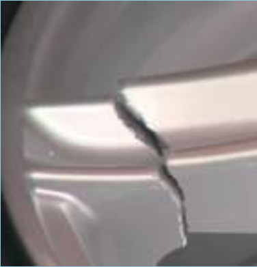
衝撃試験で亀裂の入ったホイール
