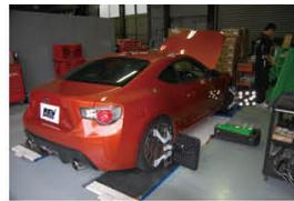
車高を下げると、サスペンションの構成パーツとタイヤとの位置関係にズレが生じる。そのままの状態では正しく走行できず、タイヤからは唸るような過大なノイズが響き、偏摩耗も進む。アライメント調整は必ず行おう
