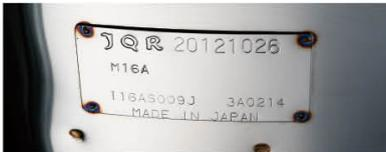
排気騒音規制値を満たす性能を有する証。交換用マフラーの事前認証制度が適用される車両用は、性能等確認済みの表示プレートがつく
