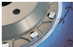
2ピース式はベルハウジングがアルミ製。軽くて、サスの動きにかかわるバネ下重量も低減できる。ローターは制動力を高めながら、生じる熱がハブ側へ伝わりにくくするタイプもある
