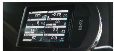
OBD (故障診断機能) が装備されていれば、対応するマルチメーターを使うとエンジン情報が簡単に見られる。状態の把握だけでなく、運転の分析や燃費走行など便利に使える
