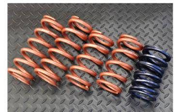
スプリングは例えばバネレートが5kg/mmなら1mm縮めるのに5kgの重さが必要。ダンパーの減衰力に余裕があればハイレート化によりロールをさらに抑えたり、グリップを高めたりもできる
