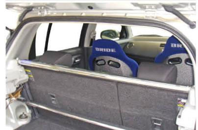
ハッチバックは開口部が広いので、Cピラーの左右を真っ直ぐつなぐピラーバーを組むと、コーナリングやレーンチェンジ時にフロントの動きに対してリアまわりの追従が高まる
