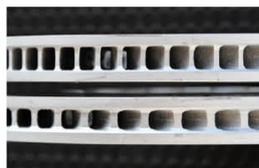
効きを保つためにローターの内部へ走行風を流して冷却し、ローターの温度を安定させる構造だ。ベン（ベンチレーター）の大きさや数、内部に設けるフィンの形状などメーカーごとに工夫がある
