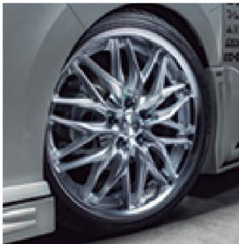
ホイール交換の基本はインチアップ。純正サイズから1～2インチ大きいホイールを履かせることで、足元に存在感が備わる。お手頃価格な1ピース、インセットをミリ単位でオーダーできる2ピース、高価だが質感が高い3ピースがある。
