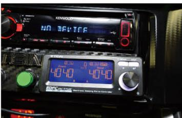
減衰力はダンパーに設けられた調整用ダイヤルを回すと調節ができるが、メーカーによってはその操作が室内から行える電子制御コントローラーを用意。走行シーンや乗員数に見合う調節がすぐに行え、変化も比較しやすい
