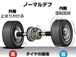
コーナリングでは車重が多くなる外輪側のサスが縮み、内輪側は伸びる。外輪が止まる一方で、内輪は接地が弱まるので前に進みにくくなる
