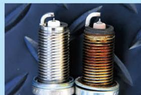
よい混合器・よい圧縮・よい火花というエンジン性能を引き出す三原則がある。スパークプラグの摩耗はパワーダウンのもと。吸気チェーン時は、高性能の新品プラグへ交換したい
