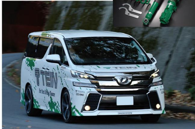
ローダウンするとドッシリ感がアップし、走行性能も安定感が増す。特にコーナリング時にふらつきが起りやすい大柄なミニバンには、有効なカスタマイズだ。リーズナブルなダウンサスや、ミリ単位で車高を調整できる車高調が人気。
