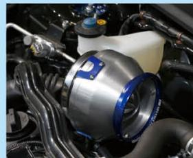
純正は吸入音が抑えられ、吸入した空気がエンジンに届くまでの経路も長い。つまり吸入抵抗が高い。マフラーと同時に交換すれば吹け上がりの軽さが増す
