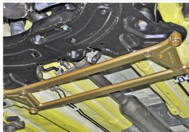
とくにFF車はエンジンとミッション、サスペンションやステアリングのすべてがつながるサスマンバーの基部をアンダーバーで固めるとハンドルの操作感とタイヤのグリップ感が高まる
