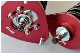
調整機構が付いているとダンパーの作動を強めたり、弱めたりと調節でき、ハンドリングやコーナリング時のロールの速さ、乗り心地が好みに合わせられる
