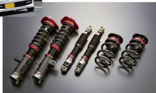
さり気なく落としたいならダウンサス、乗り味や車高を自分好みにセッティングしたいなら車高調が最適。一部のクルマは車高を落とすとリアの車軸が右または左にズレてしまうため、調整式ラテラルロッドに交換して補正する必要がある。
