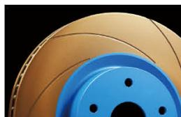
ブレーキダストの除去、温度上昇時にパッドとローター間に発生するガス抜き、制動力を増幅するなどスリットの刻み方はメーカーのノウハウ。ローターの摩耗の目安にも使える
