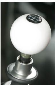
自分が握りやすい形状にしたり、高さを調整できる。また、材質が異なるものにして重量を軽く、もしくは重くするとシフトフィールを変えられ、ギアチェンジが面白くなる
