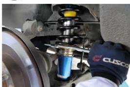
ネジ式はスプリングを支えるスプリングロアシートの位置を、全長調整式はロアブラケットの位置を回転させて調整すると、希望の車高に合わせられる
