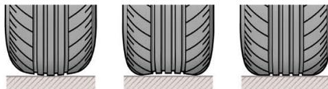
左から高すぎ、低すぎ、適正。接地が偏ると操安性が悪化。減りも早い。サイズに合う空気圧へ常に合わせよう
