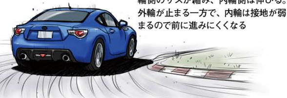
悪路や雪道では路面の抵抗の少ない側が空転し駆動力を逃がす。変化が続く路面ではタイヤの接地状態によって両輪の駆動力に差が出る
