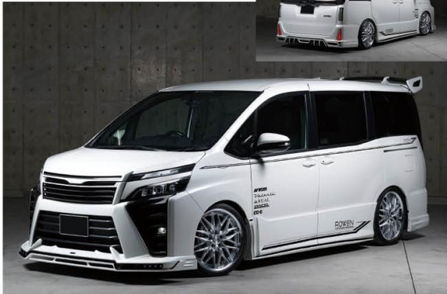
エアロパーツには様々な種類がある。イメージが大きく変わるバンパータイプに、純正バンパーのデザインを生かしたハーフタイプ、そして小振りなリップタイプ。最近ではリップよりもさらに薄い、フラップタイプも人気を集めている。
